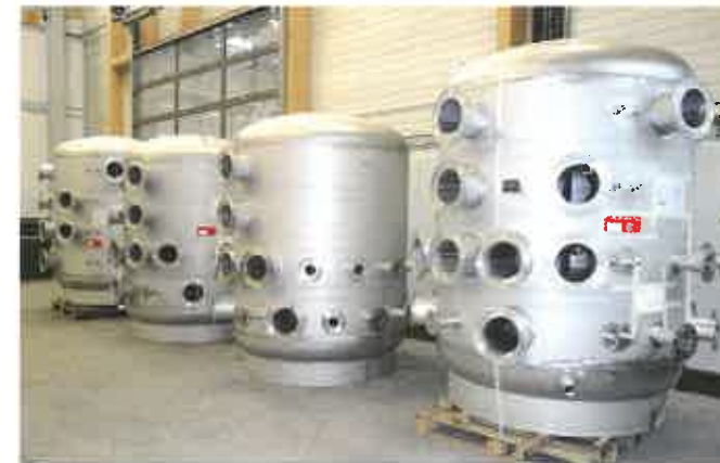
Jedes Zortström-Zentrum wird projektspezifisch sowie mit der benötigten Anzahl von Temperaturstufen geplant und gefertigt.
