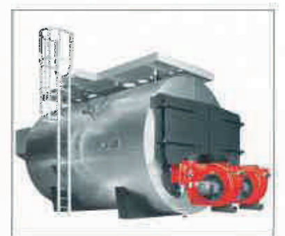
In den Doppelflammrohrkessel wurden jetzt sogenannte E-Patronen integriert, um günstigen Überschussstrom zu nutzen. Die Details hierzu im unten stehenden Beitrag. Bild: Viessmann
